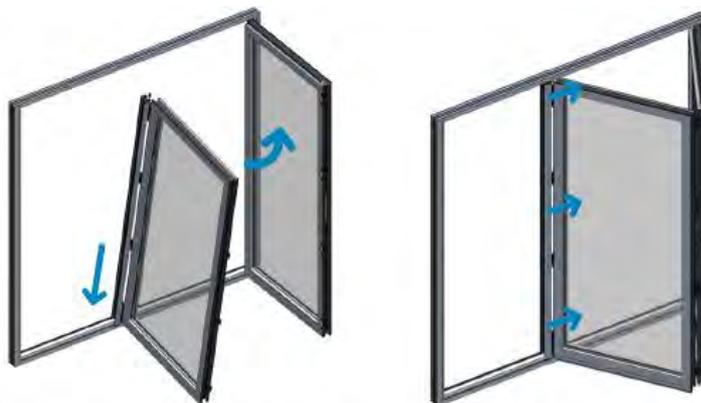
**6.** Расположить петлю над зажимной пластиной и закрепить ее через верхние и нижние отверстия винтами с потайной головкой M5x10.
