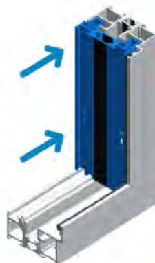
**4. Через предварительно просверленные отверстия в регулировочном профиле необходимо просверлить отверстия диаметром 4,0 мм во внешней раме для установки самонарезающих крепежных винтов.**
